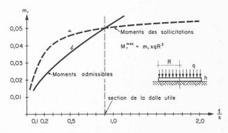
Fig. 7. — Moment de flexion maximum en fonction du rapport l/s pour une fondation circulaire sollicitée par une charge uniformément répartie.
