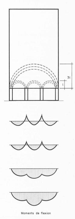
Fig. 3. — Influence possible des tassements différentiels sur les trajectoires et sur les moments de flexion d'une paroi porteuse (superstructure rigide).
