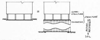
Fig. 1. — Action réciproque structure-sol.
