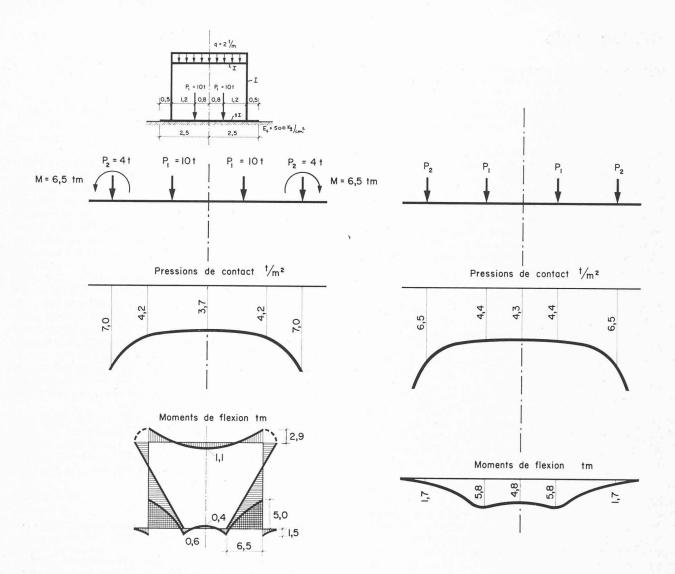
Fig. 12. — Calcul d'un cadre appuyé sur le sol.
