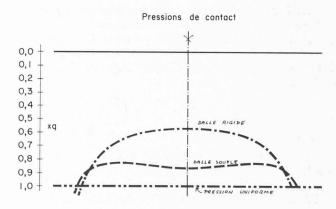
Fig. 5. — Fondation circulaire sollicitée par une charge uniformément répartie. Pressions de contact et moments de flexion.
