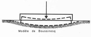
Semi-espace élastique Module de déformabilité E<sub>s</sub> t/m²
