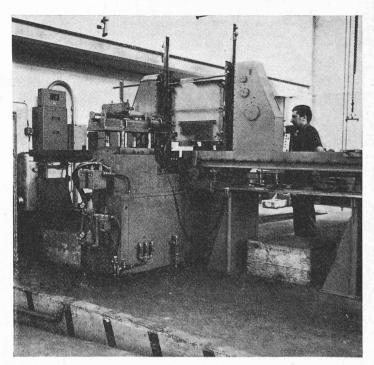
Fig. 1. — Soudeuse à commande par tyratron
