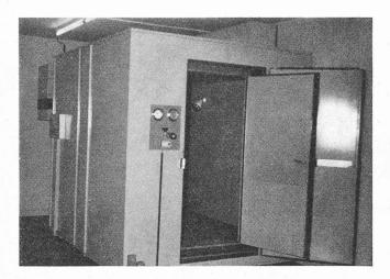
de la chambre extérieure par l'intermédiaire d'amortisseurs en caoutchouc. Un espace d'air de 10 cm sépare les deux chambres.
