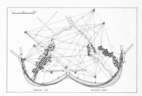
Fig. 4. — Réseau de triangulation.
