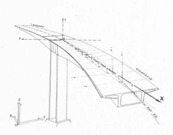
Fig. 11. — Portique à géométrie variable. Définition des systèmes d'axes.
