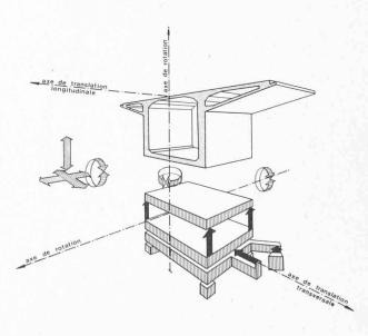
Fig. 12. — Portique à géométrie variable. Principe d'orientation d'un voussoir-moule.
