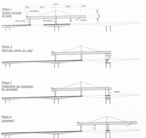
Fig. 8. — Principe et phases de pose du tablier.
