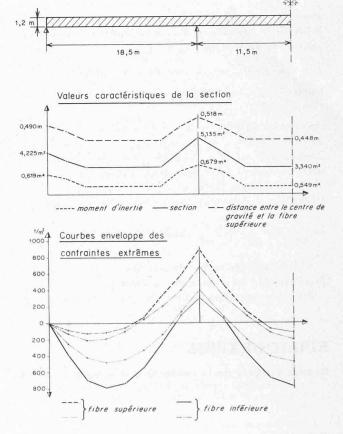
Fig. 11. — Pont symétrique à trois travées : valeurs caractéristiques de la section et les courbes enveloppes des contraintes extrêmes.
