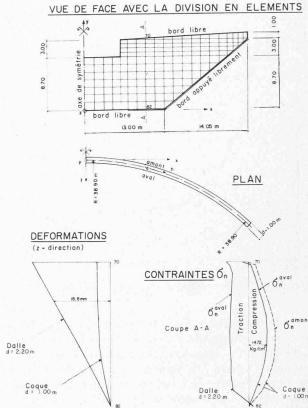
Fig. 10. — Barrage sur une rivière de montagne.
