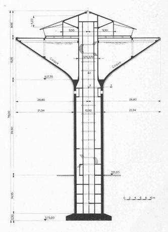
Fig. 3. — Réservoir d'eau de Riyadh : coupe verticale.
