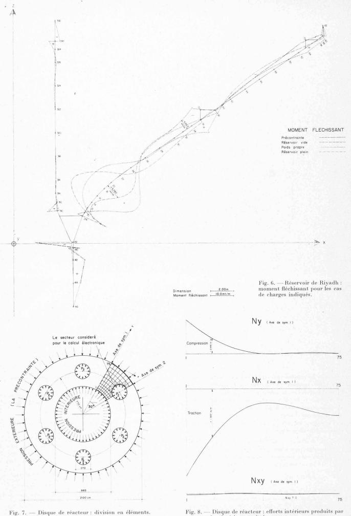
Fig. 8. — Disque de réacteur : efforts intérieurs produits par une pression intérieure unitaire.
