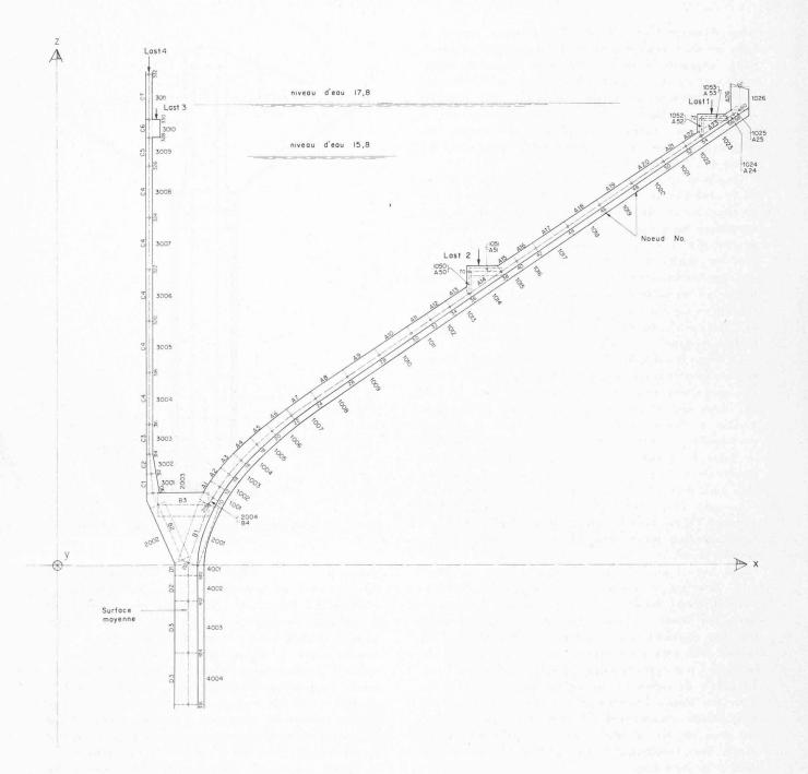
Fig. 4. — Réservoir d'eau de Riyadh : division en éléments.
