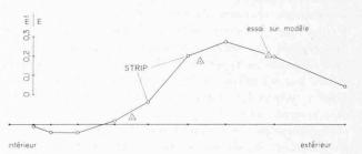
Fig. 2 b. — Coque d'Eurogas : comparaison des moments du calcul des éléments finis STRIP avec un essai sur modèle.
