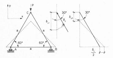
Fig. 14. — Détermination du coefficient de Poisson.
