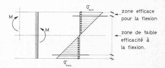
Fig. 2. — Zone mal utilisée.
