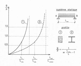
Fig. 1. — Variation du rapport  $\frac{\text{poids propre}}{\text{charge utile}}$  en fonction du rapport  $\frac{\text{port\'ee}}{\text{port\'ee limite}}$ .
