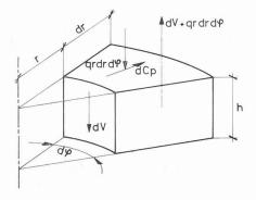
Fig. 7. — Forces agissant sur l'élément de remplissage.
