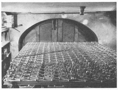
Fig. 21. — Maquette destinée à l'essai de charge: vue de dessus.
