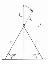
Fig. 12. - Structure de cisaillement : déplacement du sommet d'un tétraèdre élémentaire.
