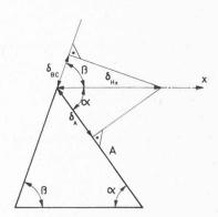
Fig. 13. — Structure de cisaillement : déplacement du sommet d'un tétraèdre élémentaire.
