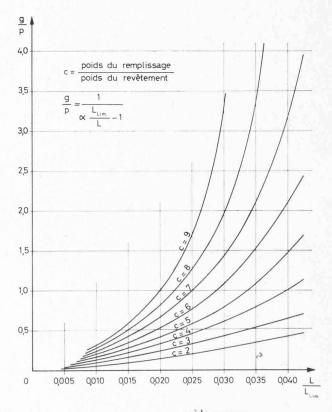
Fig. 5. — Variation du rapport  $\frac{\text{poids propre}}{\text{charge utile}}$  en fonction de la portée pour différentes valeurs de c.
