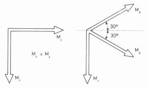
Fig. 16. — Répartition des moments de flexion selon les directions x et  $\theta$ .
