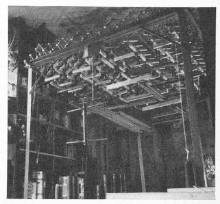
Fig. 23. — Maquette destinée à l'essai de charge : vue de dessous.
