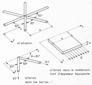
Fig. 15. — Détermination de l'épaisseur équivalente.
