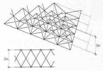
Fig. 19. — Structure cisaillée possédant un plan nodal.
