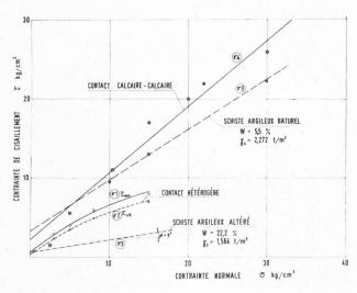
Fig. 11. — Eboulement Giro del Fullo à Gênes : Courbes intrinsèques des roches.
