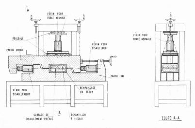
Fig. 4. — Schéma de l'appareil à cisaillement direct en laboratoire.
