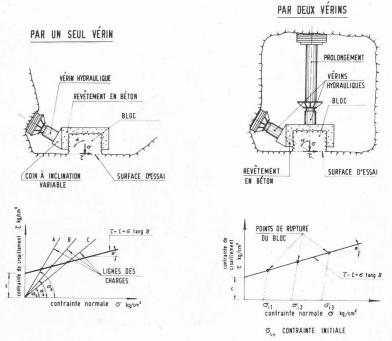
Fig. 1. — Essai de cisaillement in situ. — Schéma
