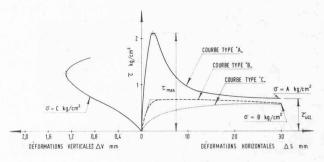
Fig. 3. — Courbes de rupture au cisaillement des roches.
