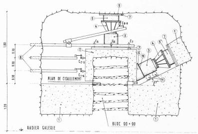
Fig. 17. — Construction du môle VII à Trieste, essai de cisaillement in situ: schéma d'applications des charges et
