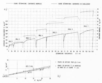
Fig. 18. — Construction du môle VII à Trieste : Essai de cisaillement in situ. b) Courbe intrinsèque de la roche.
