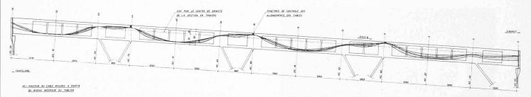
Fig. 7. — Tracé du câblage et limites de variation de celui-ci.
