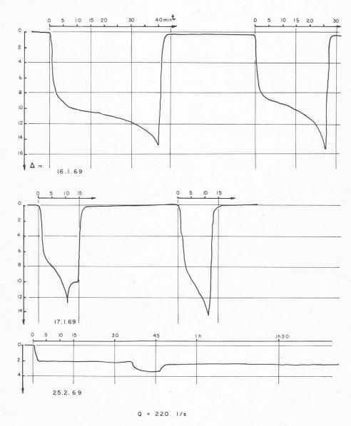
Fig. 6. — Essais de pompage. Courbes Q = f(t).
