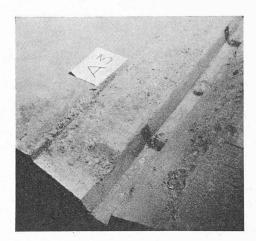
Fig. 14. — Eprouvette A 3 ; aspect des liaisons soudées après l'essai.
