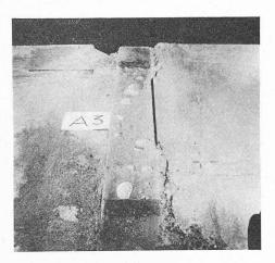
Fig. 13. — Eprouvette A 3; après l'essai. Le tronçon du mur supérieur est enlevé. Bulles d'air, sur la surface supérieure du joint.
