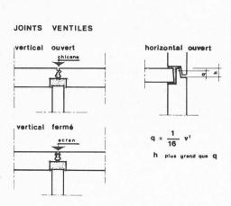
Fig. 30. — Joints entre éléments de façade : « joints remplis » ; « joints ventilés ».
