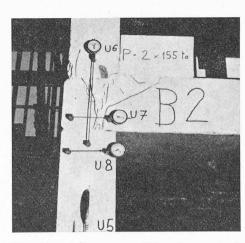
Fig. 18. — Eprouvette B 2; charge verticale: 310 t.
