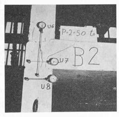
Fig. 17. — Eprouvette B 2 ; charge verticale : 100 t.
