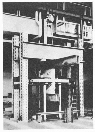
Fig. 5. — EMPA; disposition pour l'essai d'un assemblage « en croix ».
