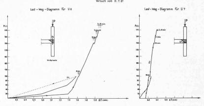
Fig. 16. — Eprouvette B 2 ; diagrammes des déformations verticales U6 et horizontales U7 sur la face arrière de l'assemblage.
