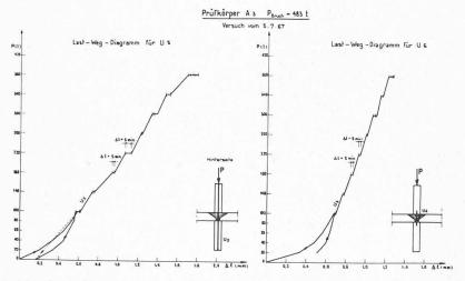
Fig. 8. — Eprouvette A 3 ; diagrammes des déformations verticales sur la face arrière de l'assemblage.
