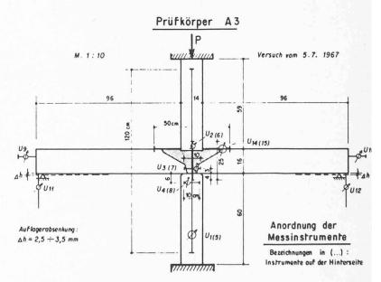
Fig. 6. — Eprouvette A 3; disposition des appareils de mesure.
