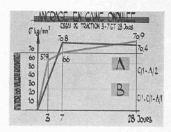
Fig. 29. — Essais de traction sur plusieurs ancrages centraux des barres Tor en gaines cannelées.
