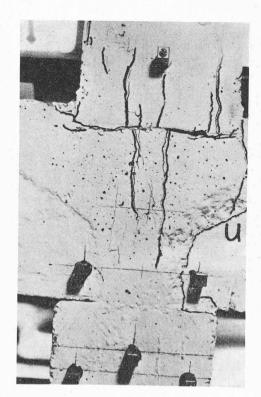
Fig. 12. — Eprouvette A 3; charge verticale: 483 t, charge de rupture. (Vue de détail.)
