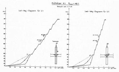
Fig. 7. — Eprouvette A 3 ; diagrammes des déformations verticales sur la face avant de l'assemblage.
