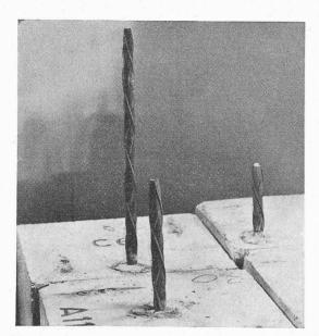
Vue de détail de trois éprouvettes après les essais. Ancrages : central, latéral, d'angle.
