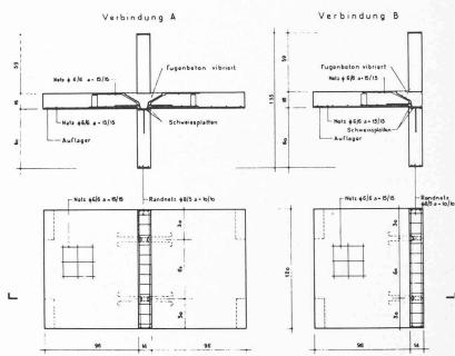
Fig. 4. — Eprouvettes ; assemblages des tronçons « en croix ».
