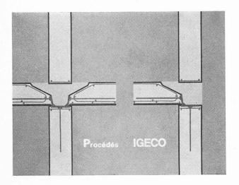
Fig. 3. — Joint de résistance dit «rigide», type «dallemur».
