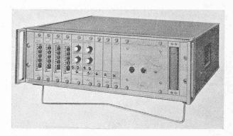
Le problème de l'adaptation des différents niveaux et logiques de sortie des voltmètres digitaux a été résolu d'une façon très élégante avec un tiroir « interface » permettant la connexion de tous les appareils à sortie BCD.
