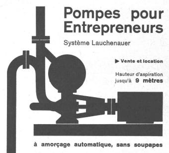
Débits de 1 à 500 litres/seconde — Pas de soupape de pied, ni de clapet dans la tubulure d'aspiration — Aucune pompe à vide de secours. — Réamorçage automatique immédiat, même si de l'air est entré dans le tuyau d'aspiration — Pas de surface de contact à frottement et s'usant, par conséquent, pas de contretemps, même pour l'élévation de la boue, du sable ou du gravier.
