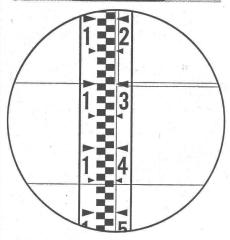
C'est l'instrument à usages multiples, à compensateur pendulaire automatique, approprié à tous les travaux de l'ingénieur. Deux traits parallèles horizontaux, visibles dans le champ de la lunette, permettent la lecture directe de la distance horizontale et de la dénivelée sur une mire verticale normale. Erreur moyenne, sur 100 m, de la distance et de la dénivelée:
