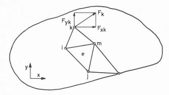
Fig. 24. — Définition des éléments et des nœuds.
