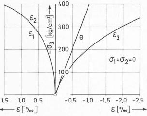
Fig. 31. — Diagramme synthétique « contrainte-déformation » pour une charge uniaxiale.
