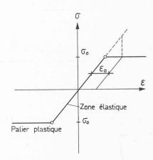
Fig. 28. — Schéma « contraintedéformation » des armatures.
