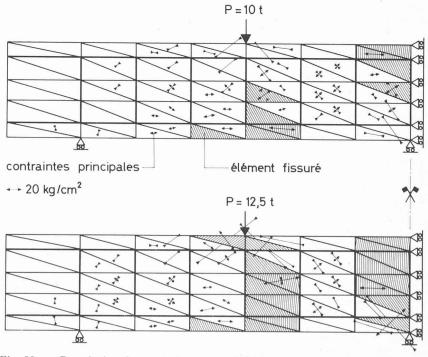
Fig. 33. — Description des contraintes dans le béton.
