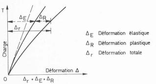
Fig. 9. — Analyse de la déformation d'une éprouvette de béton soumise à une charge uniaxiale croissante [12].
