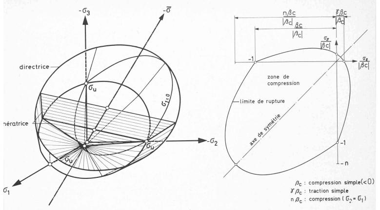
Fig. 15. - Surface tronconique de rupture du béton.
