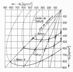
Fig. 13. — Essais de rupture en compression biaxiale [9].
