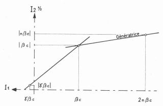
Fig. 18. — Génératrice de la surface tronconique de rupture.
