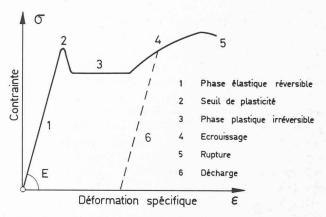
Fig. 6. — Courbe « contrainte-déformation » caractéristique de certains matériaux ductiles [13].
