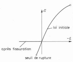
Fig. 27. — Schéma « contrainte-déformation » du béton.
