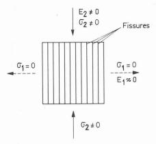
Fig. 26. — Comportement d'un élément fissuré.
