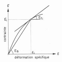
Fig. 19. — Diagramme contraintedéformation pour une charge uniaxiale.
