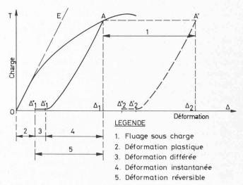
Fig. 7. — Diagramme «charge-déformation» typique du béton [12].
