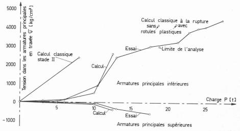
Fig. 32. — Efforts dans les armatures principales en travée.
