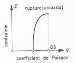
Fig. 20. — Variation dev lors d'un essai uniaxial sous charge croissante.
