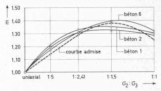
Fig. 17. — Courbes comparant la surface tronconique aux résultats d'essais en compression biaxiale.
