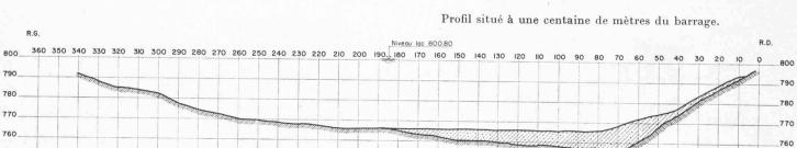
Profils établis par échosonde indiquant l'état d'envasement de la retenue.
