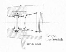
Fig. 5. — Vanne primitive de la vidange de fond.
