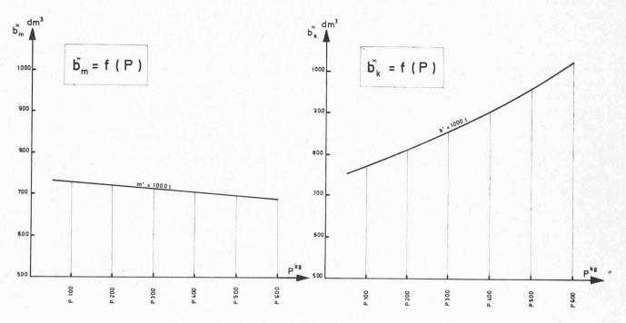
Fig. 1. — Rendement d'une bétonnière.
