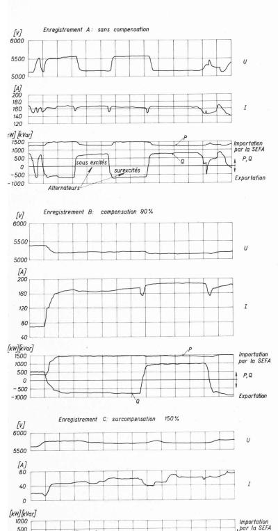
Fig. 8. — Enregistrement du courant I, de la tension composée U et des puissances active et réactive importées, mesurées dans l'interconnexion à l'étage 6 kV.
