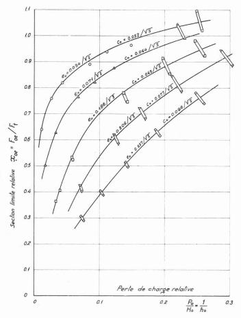
Fig. 20. — Valeurs expérimentales de la section limite relative  $x_{0e}$ .
