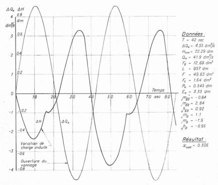
Fig. 22. — Variations calculées de la charge pour oscillation sinusoïdale du vannage (calcul par différences finies selon méthode détaillée du chapitre 3).
