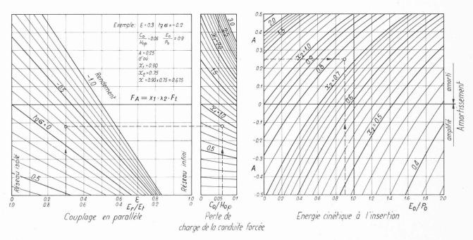
Fig. 23. — Section horizontale relative de la chambre d'équilibre telle que les petites oscillations à puissance constante subissent un amortissement donné, compte tenu de l'énergie
