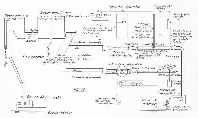
Fig. 10. — Schéma général de l'installation d'essai.
