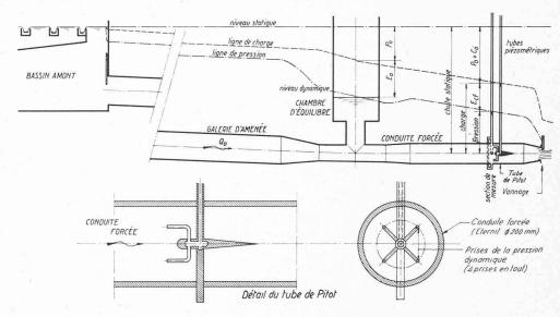
Fig. 12. — Dispositif de mesure de la charge hydraulique dans la conduite forcée.
