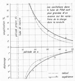
Fig. 13. — Amplification et déphasage des oscillations dans le tube de Pitot de mesure de la charge.
