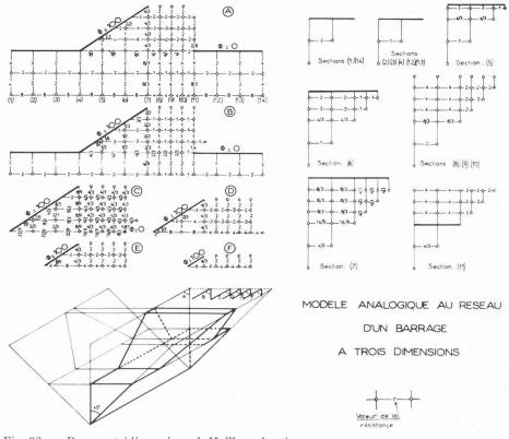
Fig. 32. — Barrage tridimensionnel. Maillage des six coupes.
