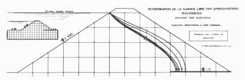
Fig. 26. — Réseaux résistifs. Recherche d'une surface libre par injections.
