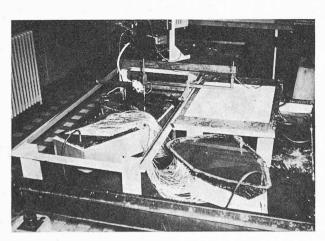
Fig. 42. — Digue de Serre-Ponçon. Bassin tridimensionnel en essai.
