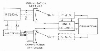
Fig. 45. — Principe du calcul hybride par réseaux.
