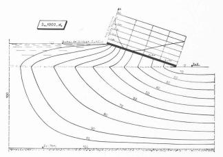
Fig. 36. — Canal du Rhône. Champ pour une configuration.
