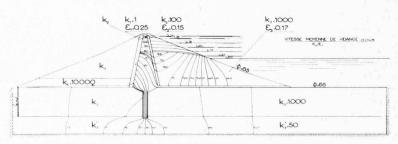
Fig. 40. — Digue de Serre-Ponçon. Vidange lente de la retenue.
