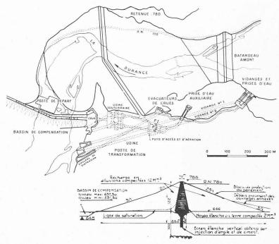
Fig. 38. — Digue de Serre-Ponçon. Site et coupe.
