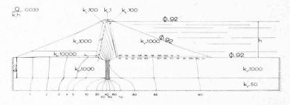
Fig. 39. — Digue de Serre-Ponçon. Champ permanent.
