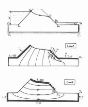
Fig. 4. — Papier conducteur. Imposition des conditions aux limites.
