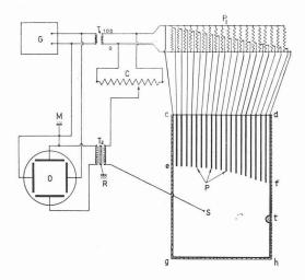
Fig. 15. — Drainage d'un terrain. Représentation à la cuve rhéoélectrique.
