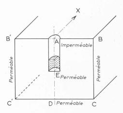
Fig. 17. — Tranchée avec crépine. Schéma du domaine.
