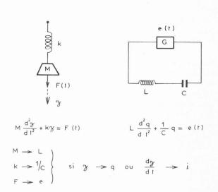
Fig. 1. — Exemple de modèle analogique.
