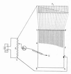
Fig. 14. — Drainage d'un terrain. Représentation au papier conducteur.
