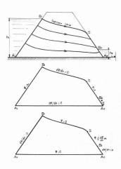
Fig. 3. — Papier conducteur. Définition des conditions aux limites.
