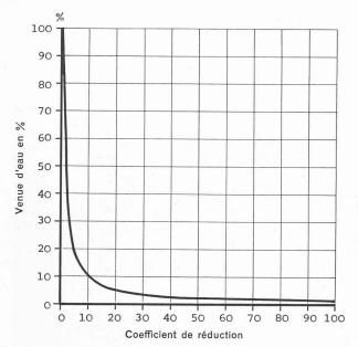
Fig. 8. — Diminution de la venue d'eau en fonction du coefficient de réduction.
