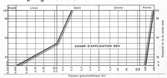
Fig. 5. — Sols se prêtant au compactage en profondeur.
