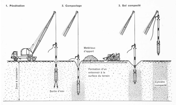
Fig. 3. — Phases de compactage.
