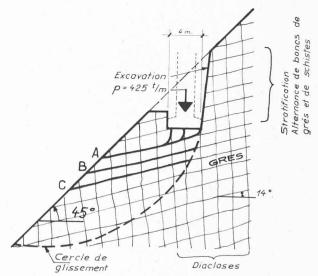
Fig. 13. — Fondation d'une pile de pont.
