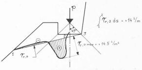
Fig. 16. — Etat de contrainte dû au poids propre et à la surcharge.
