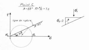
Fig. 5c. — Etat de contrainte au point C.
