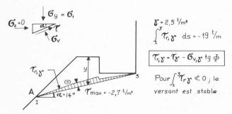
Fig. 14. — Etat de contrainte dû au poids propre.
