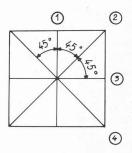
Fig. 6. — Quatre systèmes de discontinuité décalés de 45°.
