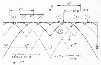
Fig. 7. — Diagrammes de R pour quatre systèmes de joints décalés de 45°.
