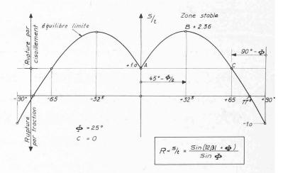
Fig. 4. — Diagramme de R pour  $\Phi = 25^{\circ}$ .
