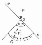
Fig. 11. — Etat de contrainte dû à une charge concentrée agissant sur une surface inclinée.
