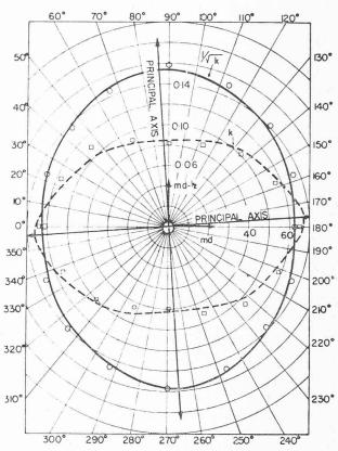
Fig. 5. — Diagramme de perméabilité polaire. Les valeurs de la perméabilité mesurées (k) sont reliées par une courbe compliquée (pointillée). Si l'on reporte les valeurs de  $k^{-\frac{1}{2}}$  (petits cercles) on s'aperçoit qu'elles s'alignent fort bien sur une ellipse. Cette application concrétise la théorie du tenseur de perméabilité.
