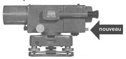
Sur le niveau automatique est contrôlée d'ingénieur Wild NA2 (NAK2) avec nouveau compensateur: Plus de tapottement sur le trépied
