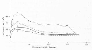
Fig. 5. — Essais de résistance au cisaillement à différentes vitesses de rotation de la sonde à palette 1.
