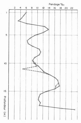
Fig. 3. Mesures à l'inclinomètre du pendage d'un forage tubé S II.
