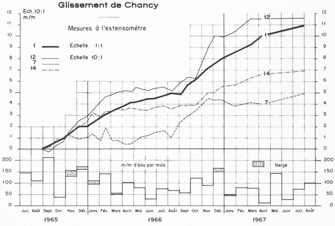
Fig. 2. — Ouverture, en millimètres (point 1), en dixièmes de millimètre (points 7, 12, 14) de fissures dans des ouvrages atteints par les glissements de terrain. Pluviométrie.
