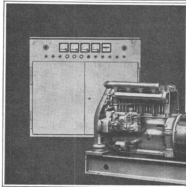
Moteur Diesel 25 kVA, 50 Hz, 380 V
