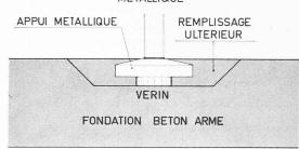
Fig. 29. — Détail d'un poteau métallique.
