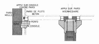
Fig. 32. — Appuis de la charpente.
