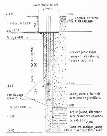
Fig. 14. — Coupe du puits d'essai.
