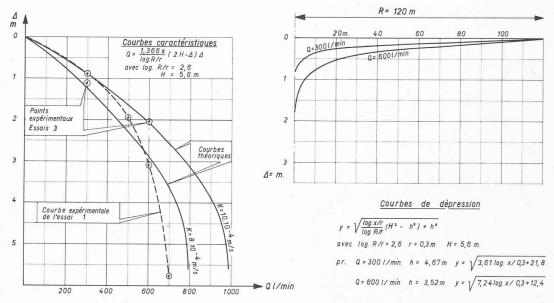
Fig. 15. — Théorie de Dupuit — écoulement permanent. Courbe caractéristique et courbes de rabattement de l'essai de Cressier.
