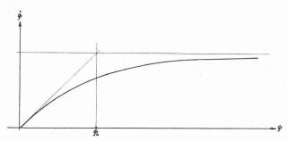
Fig. 1. — Réponse d'une hélice initialement arrêtée dans un vent de vitesse constante.
