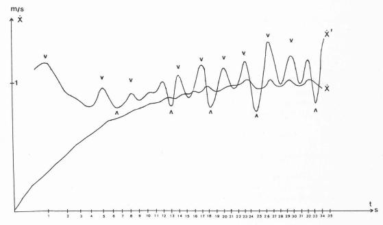
Fig. 6. — Graphique de la réponse  $\dot{x}$  et  $\overline{\dot{x}}$  d'une hélice NEZ
