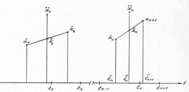
Fig. 5. — Graphique des différents paramètres: vitesse mesurée  $\dot{x}$ , accélération  $\ddot{x}$ , vitesse corrigée  $\overline{\dot{x}}$  correspondant aux différentes époques t,  $\overline{t}$  et  $\overline{\overline{t}}$ .
