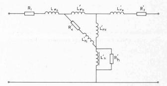
Fig. 4. — Schéma équivalent rapporté au primaire d'un transformateur de tension avec enroulement de compensa-
