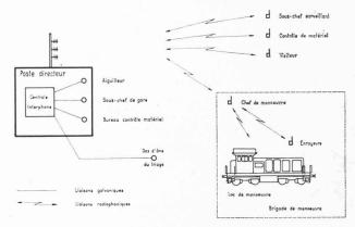
Fig. 25. — Réseau automatique d'interphones et de radio.
