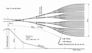
Fig. 24. — Tête de faisceau de Lausanne-triage. Bosse de débranchement double (plan et profil).
