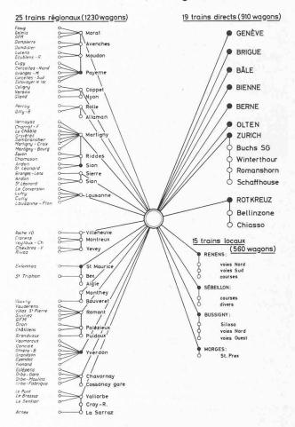
Fig. 6. — Formation des trains à la gare de Lausanne-triage.
