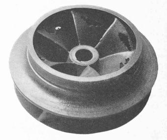
Fig. 11. — Destruction d'un aubage moteur de pompe par cavitation.
