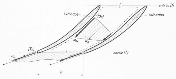
Fig. 8. — Répartition des vitesses relatives à l'intérieur et à la sortie d'un canal d'aubage moteur.
