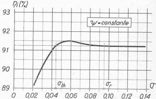
Fig. 9. — Rendement interne  $\eta_i$  de la turbine en fonction du chiffre de cavitation  $\sigma$ , à énergie  $\psi$  constante.  $\sigma_{th}$ : apparition de la cavitation à la sortie de
