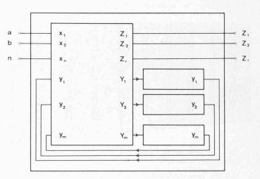
Fig. 4. — Représentation schématique d'un système logique séquentiel dans lequel la mémorisation est assurée par des rétroactions positives conditionnelles.
