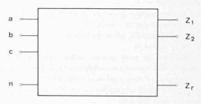
Fig. 1. — Représentation schématique d'un système logique.
