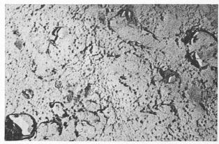
Fig. 11. — Surface d'or érodée par ultrasons. Vue identique pour une surface de corindon attaquée au jet.
