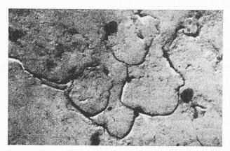
Fig. 10. — Surface d'aluminium érodée (vues identiques lorsque la cavitation est due aux ultrasons ou à l'impact d'un jet).
