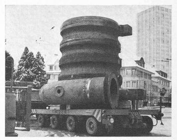
Fig. 6. — Transport du corps de pompe entre deux ateliers d'usinage, à Winterthour. Poids de la pièce terminée : 80 t.
