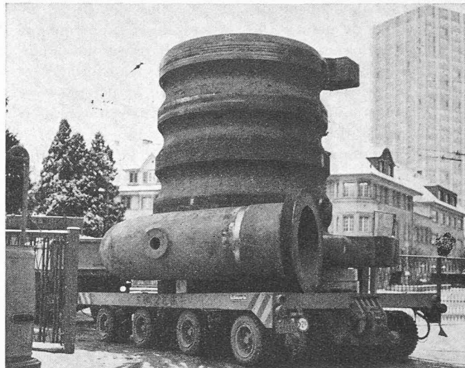
Fig. 6. — Transport du corps de pompe entre deux ateliers d'usinage, à Winterthur. Poids de la pièce terminée : 80 t.
