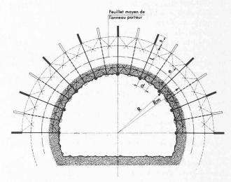
Fig. 13. — Soutènement boulonné (selon Talobre).
