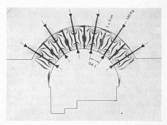
Fig. 25. — Essais photoélasticimétriques dans un milieu homogène.
