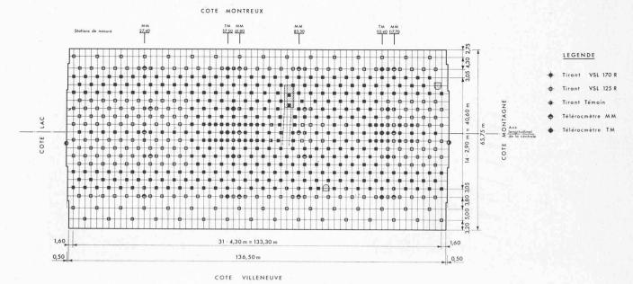
Fig. 10. — Voûte et parois développées. Disposition des tirants en rocher, tirants témoins et télérocmètres.
