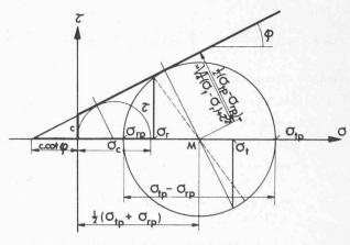
Fig. 17. — Condition de plasticité, basée sur une courbe intrinsèque rectiligne (cercles de Mohr).
