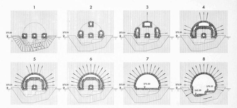
Fig. 3. — Etapes d'excavation, profils en travers
