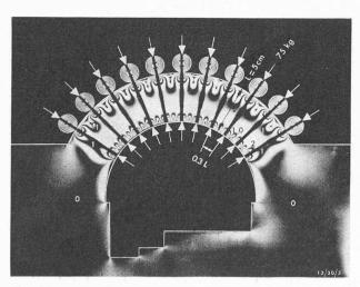
Fig. 24. — Essais photoélasticimétriques dans un milieu homogène.
