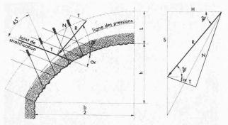
Fig. 15. — Représentation schématique d'un anneau porteur naturel créé par ancrage. Forces agissant le long d'un joint continu (selon Rabcewicz).
