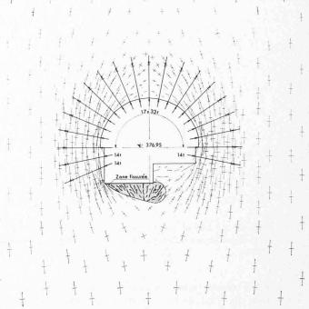
Fig. 20. — Calcul par la méthode des éléments finis.
