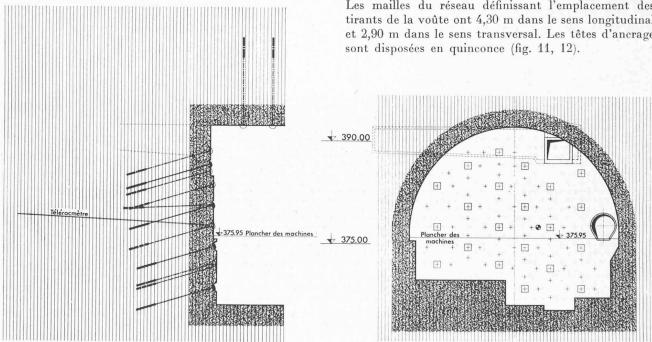
Fig. 9. — Tympan côté montagne. Disposition des tirants précontraints.
