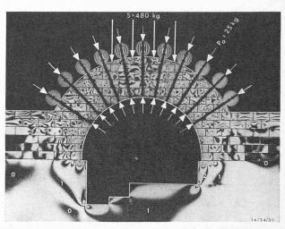
Fig. 28. -- Essais photoélasticimétriques dans un milieu
