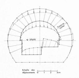
Fig. 22. — Calcul par la méthode des éléments finis. Déplacement du rocher autour de la caverne dans un milieu élas-
