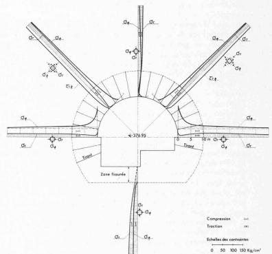
Fig. 21. — Calcul par la méthode des éléments finis.
