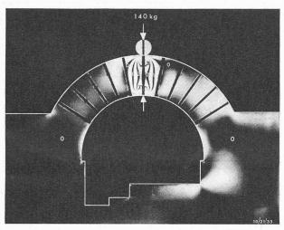
Fig. 23. — Essais photoélasticimétriques dans un milieu homogène.
