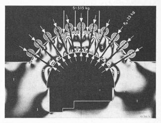
Fig. 26. — Essais photoélasticimétriques dans un milieu homogène.
