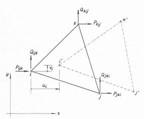
Fig. 11. — Elément de disque typique.
