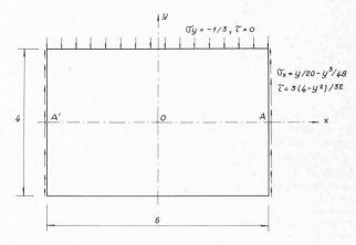
Fig. 13. — Exemple illustratif: poutre uniformément chargée.
