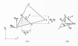
Fig. 12. — Détermination des forces nodales.
