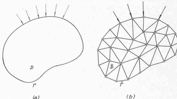
Fig. 10. — Disque sollicité par des forces coplanaires.
