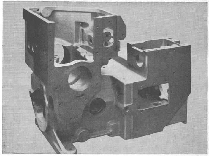
Boîte de chasse étanche à l'huile, en fonte grise spéciale, pour une machine textile. En cas de fabrication en série, nous garantissons pour la pièce brute une exactitude maximale des cotes.
