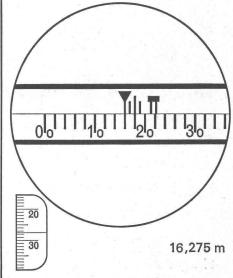
Ce stadimètre à double image, d'une construction des plus modernes, est l'instrument approprié à la mensuration cadastrale. La lecture des distances est particulièrement simple, grâce à l'absence de vernier sur la mire. Un prisme additionnel permet la correction de l'erreur personnelle. Erreur moyenne des distances sur 100 m:
