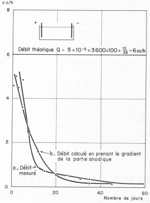
Fig. 2. — Evolution des débits en cours d'électro-osmose.
