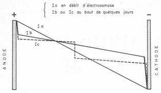
Fig. 1. — Evolution des potentiels en cours d'électro-osmose.
