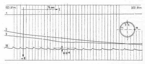
Fig. 17. — Mesure des effets dynamiques effectuée sur un voussoir lors de la phase d'avance du bouclier.
