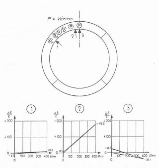
Fig. 18. — Variation des déformations d'un voussoir mesurée en trois points en fonction de la pression exercée par les vérins de poussée du bouclier.
