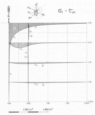
Fig. 16. — Répartition des contraintes de cisaillement  $\tau_{hv}$  et  $\sigma_t$  dans un demi-espace élastique sous une force concentrée de 1000 tonnes.
