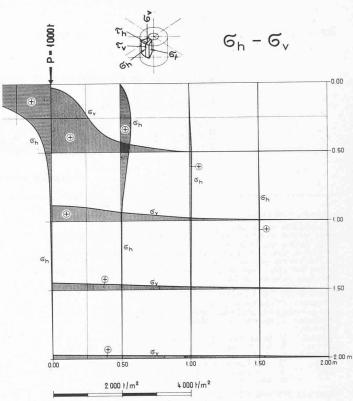
Fig. 15. — Répartition des contraintes principales  $\sigma_h$  et  $\sigma_v$  dans un demi-espace élastique sous une force concentrée de 1000 tonnes.
