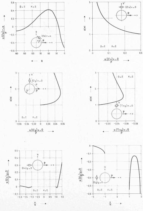
Fig. 20. — Répartition des contraintes  $\sigma$  et  $\tau$  au voisinage d'une galerie circulaire en un point d'abscisse x et y sous l'action d'une force radiale P appliquée en un point situé à une distance 2R du centre de la galerie.
