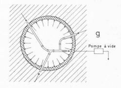
Fig. 29. — Différents systèmes pour appliquer une précontrainte au rocher entourant une galerie.
