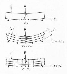
Fig. 23. — Contraintes et déformations d'une poutre assemblée.
