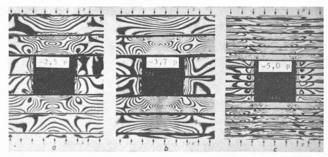
Fig. 26. — Modèle photoélastique en milieu feuilleté avec intercalation de caoutchouc. D'après le professeur Sonntag. Munich. Forschungsbericht Nr. 861 des Landes Nord-Rhein Westphalen.
