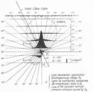
Fig. 14. — Répartition dans le sol des contraintes  $\sigma_v$  d'un ancrage oblique ponctuel de 22 tonnes.
