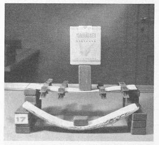
Fig. 22. — Modèle montrant l'effet d'une précontrainte perpendiculaire aux feuillets.
