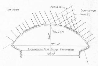
Fig. 13. — Aménagement des «Snowy Mountains» (Australie). Voûte de la centrale souterraine de «Tumut».
