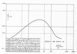
Fig. 6. — Quelques interprétations équivalentes d'un sondage électrique de forme analogue à la courbe 18 de la figure 5.
