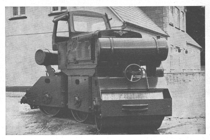
Poids de service uniformément réparti. Chaque cylindre agit indépendamment. Braquage de 30° permet un rayon intérieur de 3 m seulement. 5 positions différentes de travail. Moteur Ford-Diesel, 4 cylindres, 40,6 CV à 1600 t/min, refroidi à l'eau, avec démarreur électrique.
