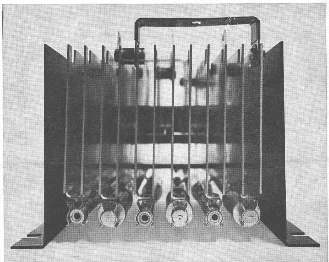
pont redresseur triphasé 300 A 220 V, avec éléments RC
