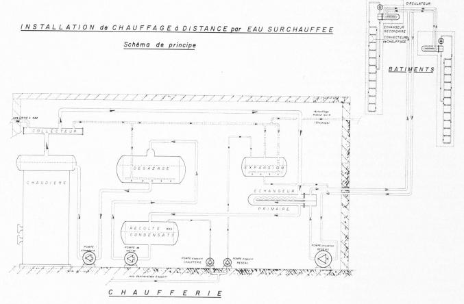
Fig. 4. — Schéma de principe.
