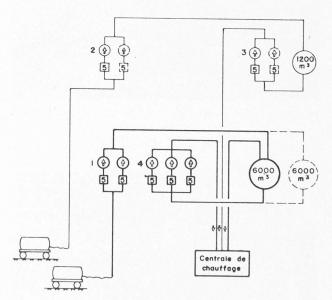
Fig. 10. — Principe de fonctionnement de l'installation de dépotage.
