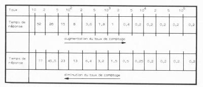
Fig. 5. — Temps de réponse de l'intégrateur logarithmique à une entrée variant par sauts pour différentes valeurs initiales.
