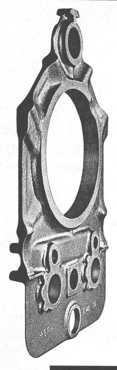
Cette cloison d'extrémité, élément constitutif d'un bâti de moteur Diesel de 2400 CV, pèse 84 kg.
